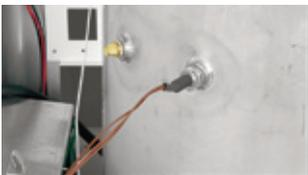
罐体上标准配备2处传感器接口。 可选购记录仪和高性能的压力计。
